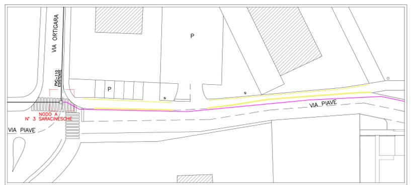
PLANIMETRIA RETE FOGNARIA - DETTAGLIO COLLEGAMENTO SU RETE ESISTENTE
